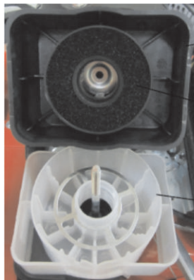
Основание фильтра с масляной ванной
