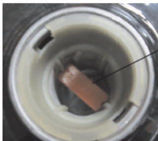
Красная метка максимального уровня топлива в баке
